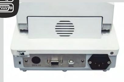
Возможность подключения принтера (опция) или ПК для протоколирования результатов взвешивания через встроенные интерфейсы RS-232C и USB;
