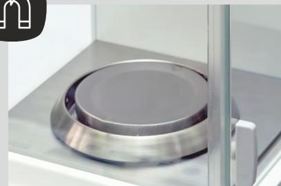
Корпус весов выполнен из алюминиевого сплава, что увеличивает механическую износостойкость и электромагнитную защищенность прибора;
