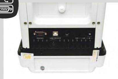
Встроенный интерфейс RS-232, два порта USB и **Ethernet** (опция) позволяют осуществлять подключение к весам: ПК, принтера чеков, портативной клавиатуры, сканера штрих кодов, а также использовать внешний USB-накопитель\*;
