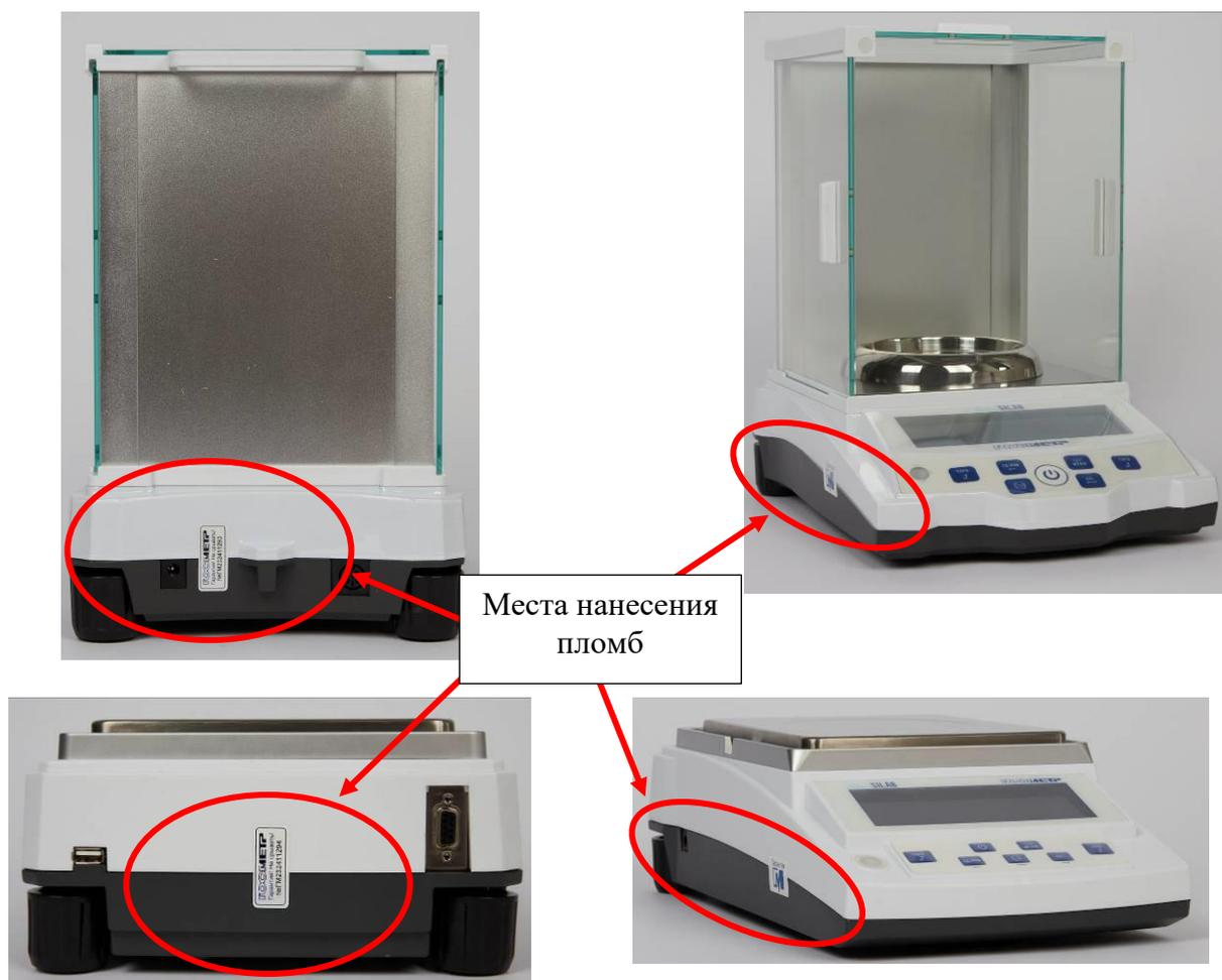
Рисунок 3 – Места нанесения пломб
