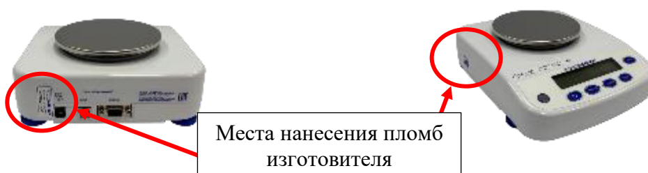
Рисунок 5 – Схема пломбировки для весов ВТ
