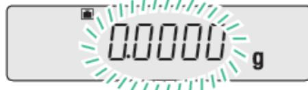
**4 Снимите юстировочную гирю с чашки весов:**
