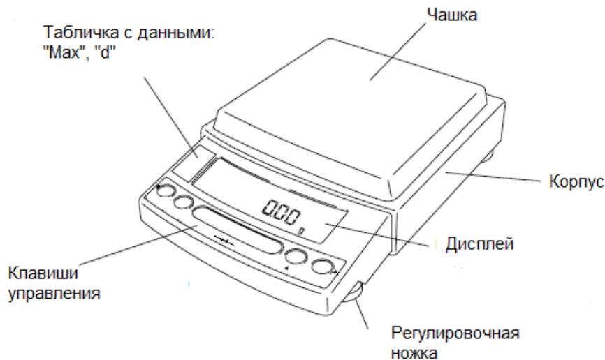
Рисунок 1- Компаратор массы ВЛЭ-6202К
