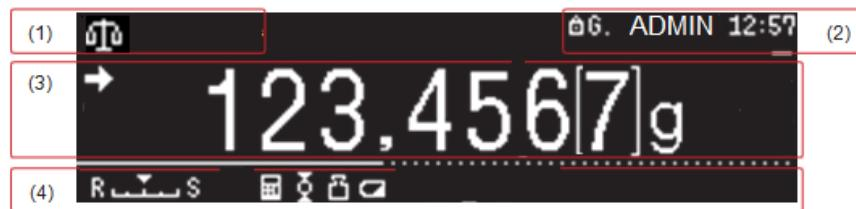
Рисунок 4 – Дисплей весов (изображение для режима стандартного взвешивания)
